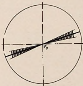
Bild 9. Linearer Teil der Demodulations-Charakteristik wie er bei einem Hub von 75 kHz auf dem Schirm des Oszillografen erscheint. Der Ratiodetektor wird mit einem Sinussignal von 3000 Hz moduliert (Schmetterling)
