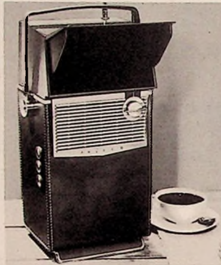
Philco brachte im Juni den ersten batteriege-speisten, wirklich transportablen Fernsehempfänger mit 21 Transistoren heraus
