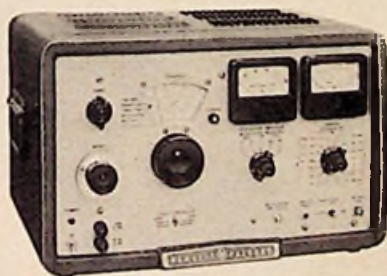
Modell 606 A Meß-Sender 50 kHz - 65 MHz
